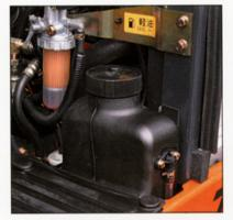
Kraftstofftank mit großem Fassungsvermögen und breitem Einfüllstutzen
